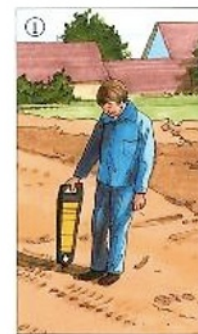
fig. 04 – uso rilevatore sottoservizi
