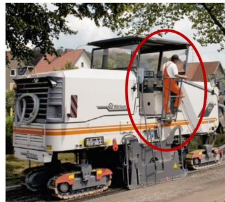
Fig. 06 - Protezione del posto di guida scarificatrice
